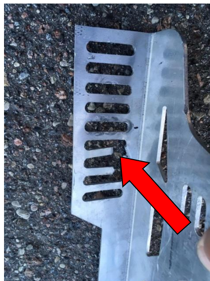
Laikiklio pažeidimai atsiradę kaip technologinė, avarijos ar eksploataavimo pasekmė
