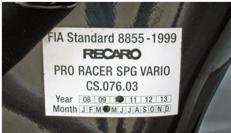
Senojo tipo etiketės pavyzdys, kuriame nurodyta sėdynės pagaminimo data (be holograminio lipduko)
