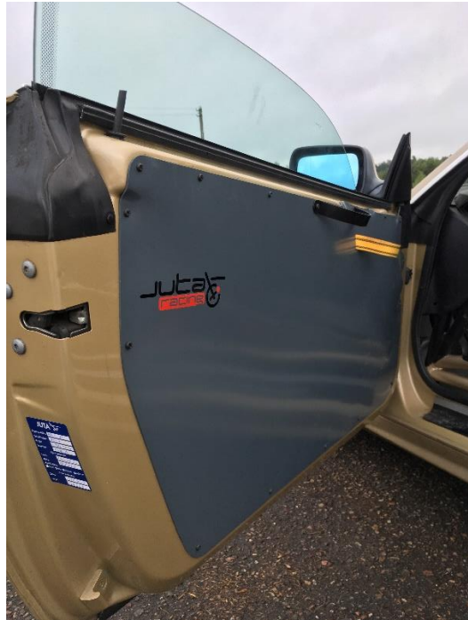
Iš PVC plastiko (nulinė degumo klasė) pagaminta durų apdaila
