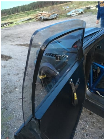
Pavyzdinčiai atliktas lango tvirtinimas duryse be originalaus lango rėmelio
