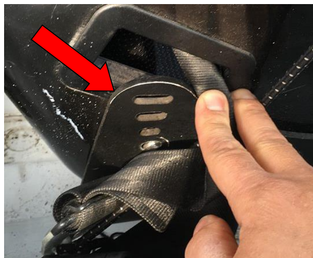
Laikiklio pažeidimai atsiradę kaip technologinė, avarijos ar eksploataavimo pasekmė
