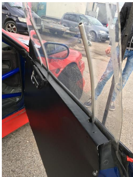
Pavyzdinčiai atliktas lango tvirtinimas duryse be originalaus lango rėmelio
