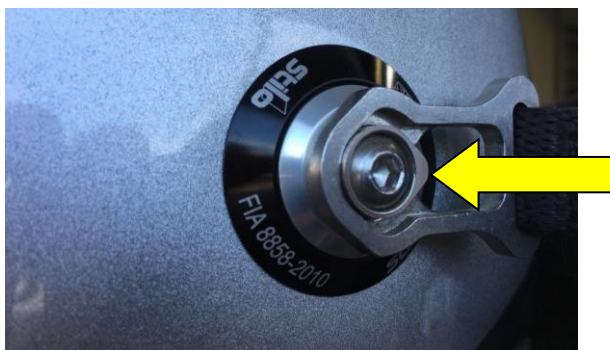
Tvirtinimo elemento kumštelis (pažymėtas rodykle) privalo būti nukreiptas atgal FHR dirželio kryptimi
