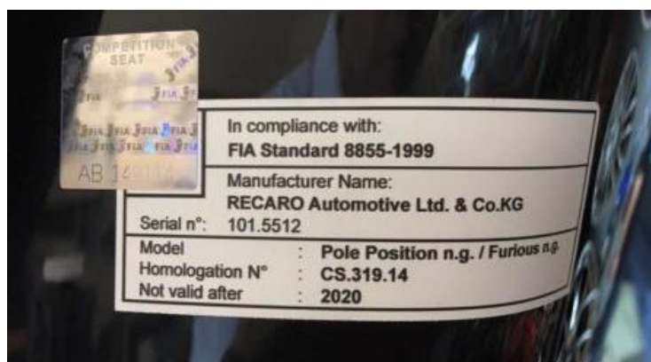
Naujausio tipo etiketės pavyzdys, kuriame nurodyti sėdynės homologacijos galiojimo pabaigos metai (su holograminiu lipduku)
