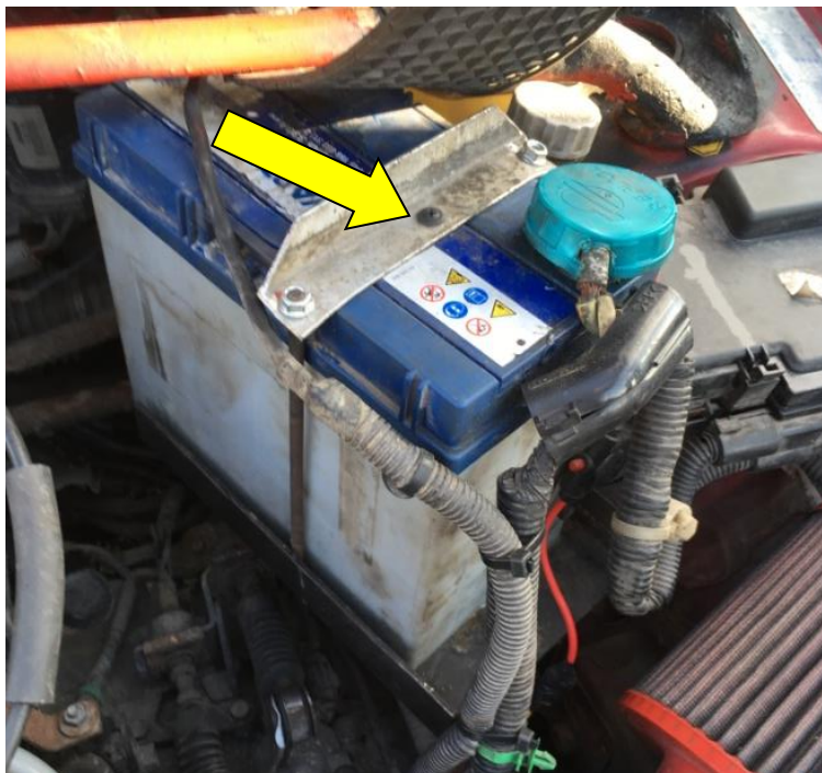
Variklio skyriuje originalioje vietoje įrengta baterija. „Plus“ poliaus uždengimas privalomas
