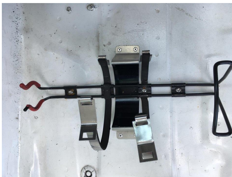
Modifikuotas gesintuvo laikiklis, su pridėtiniais lizdais (loveliais) gesintuvo stabilizavimui skersine kryptimi
