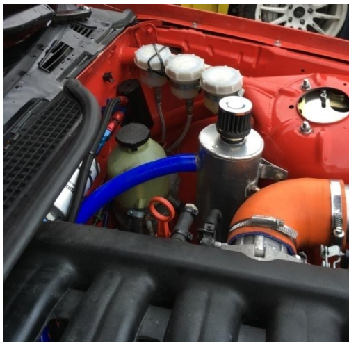
Tinkamai įrengti stabdžių sistemos „pedalbox“ bakeliai
