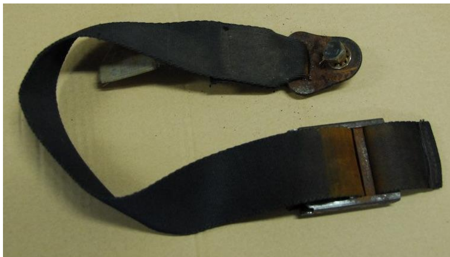
Korozija daro didelę įtaką diržų fiksavimo elementų paslankumui, o tas gali nulemti diržo atsipalaidavimą avarijos metu
