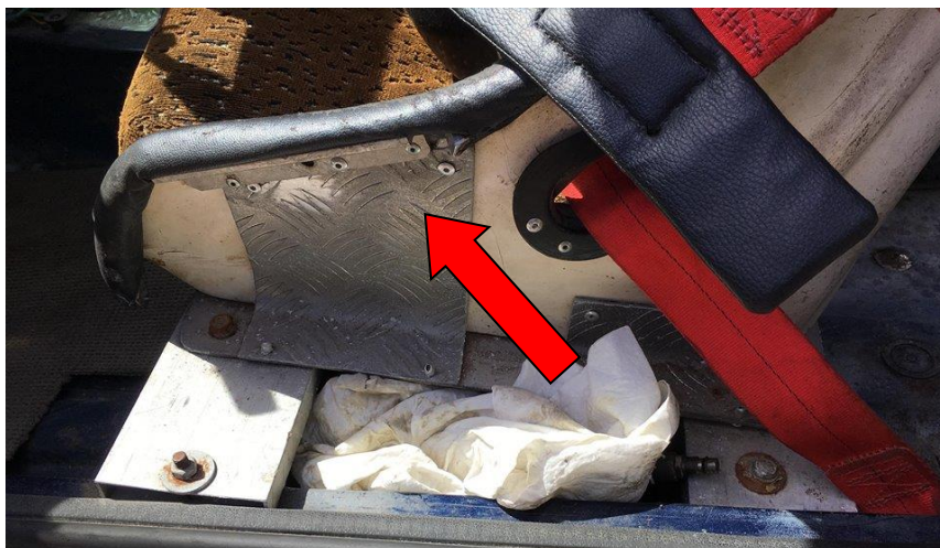
Neatitiktis: sėdynė sutvirtinta papildomais elementais, kad padidinti standumą
