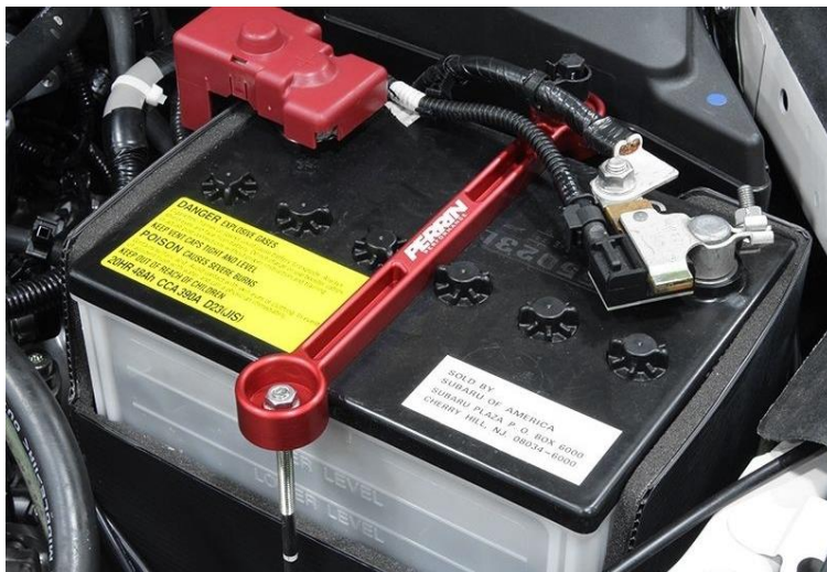
Variklio skyriuje originalioje vietoje įrengta baterija. „Plus“ poliaus uždengimas privalomas
