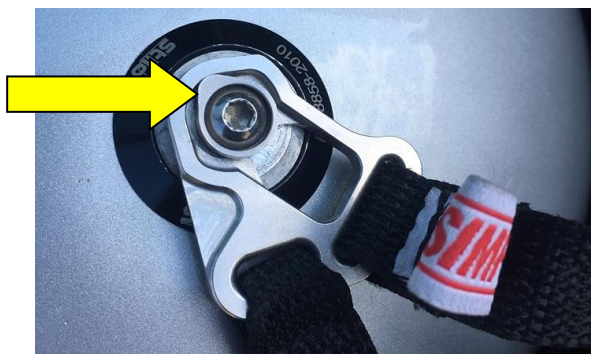
Neatitikimas: tvirtinimo elemento kumštelis nukreiptas į priekį
